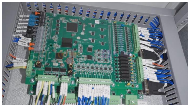
图 17：许继电气 PCS 控制电路板
