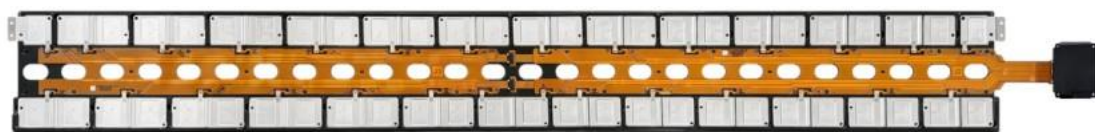
■ 图13 FPC直连BMU方案（26S主动均衡BMS）
