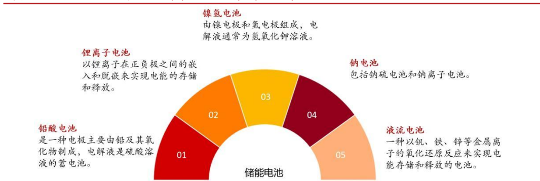
图表 2：储能电池可分为锂离子电池、镍氢电池等
