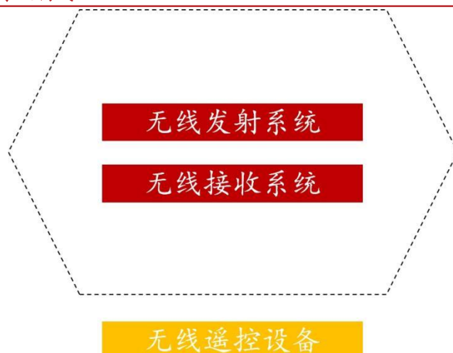
图表 7：工业无线遥控设备由无线发射系统及无线接收系统构成
