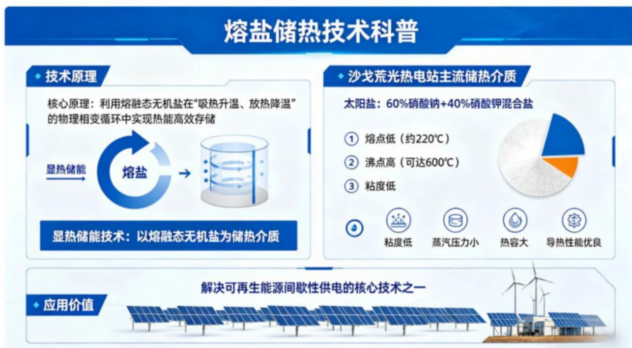
图1：熔盐储热是一种以熔融态无机盐为储热介质的显热储能技术
