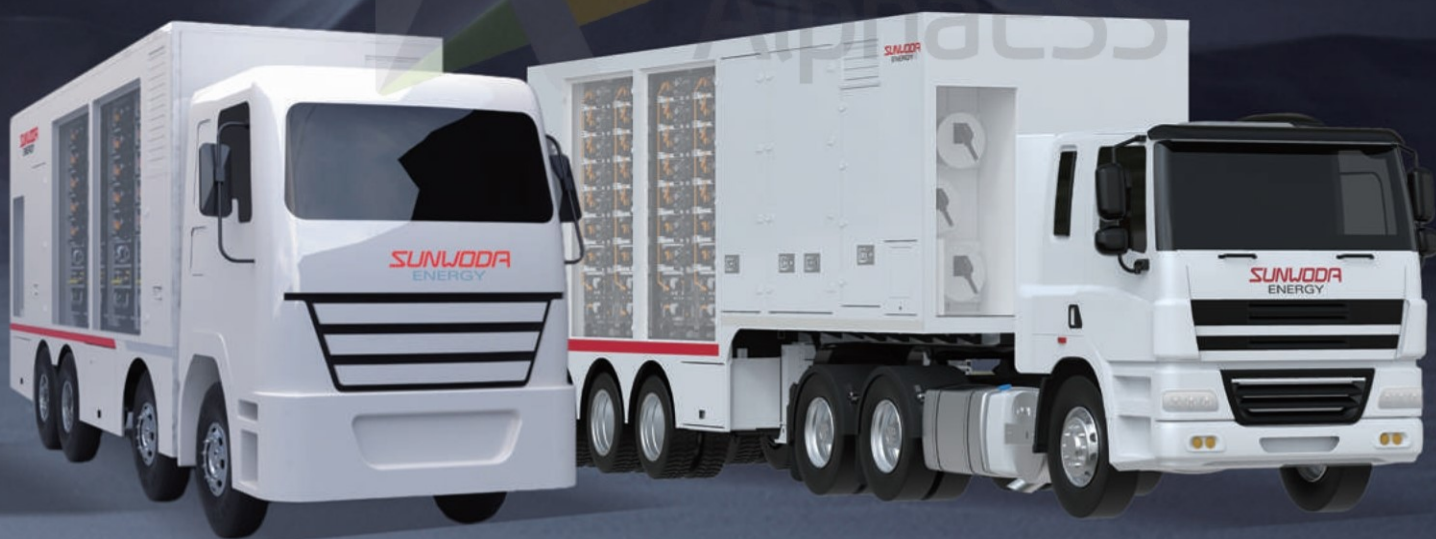
10米级2MWh移动储能车
