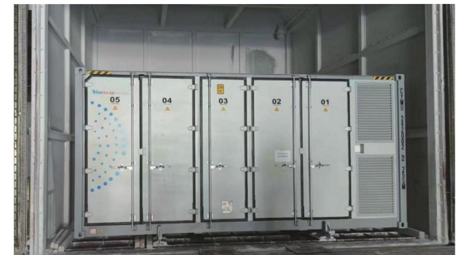
图26 电池舱IP5X防尘测试
