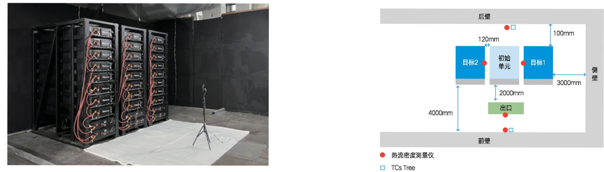
图28 热失控试验布置示意图（图片来源：天合储能实测拍摄）
