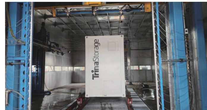
图25 电池舱IPX5防水产品评估IEC 60529测试
