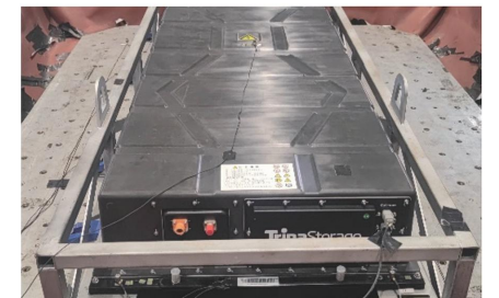
图27 电池模块振动试验（图片来源：天合储能实测拍摄）
