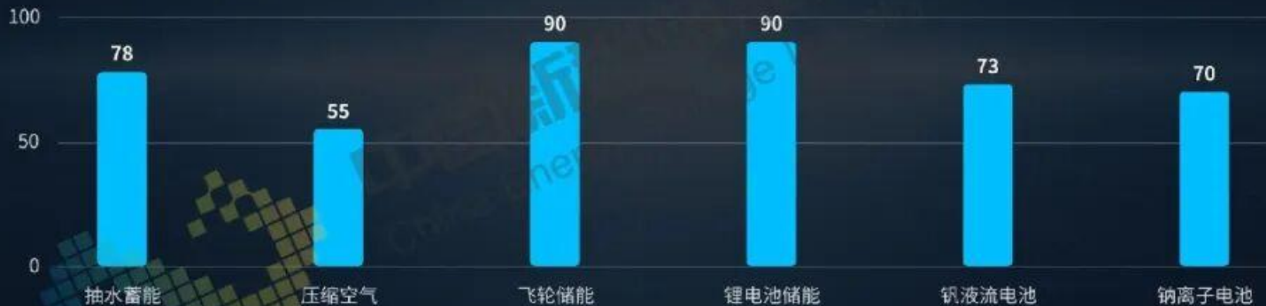
主流储能技术“电-电”转换效率 (%)
