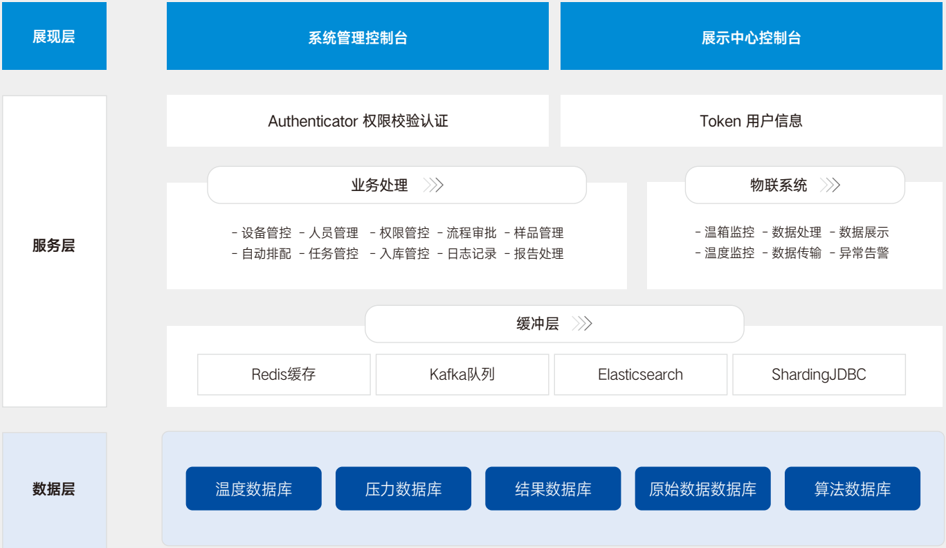
图23 LIMS系统架构展示图
