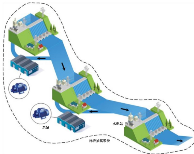
图 1-2 储能泵站示意图
