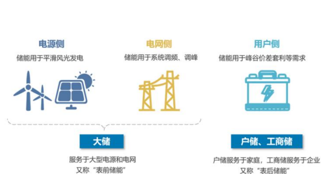
图 2：消费级储能位于电力系统用户侧
