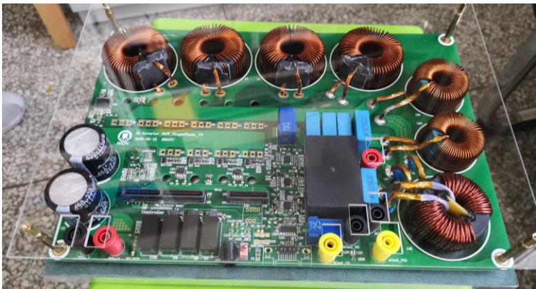
大功率电能变换装置的 磁性元件体积大、重量重
