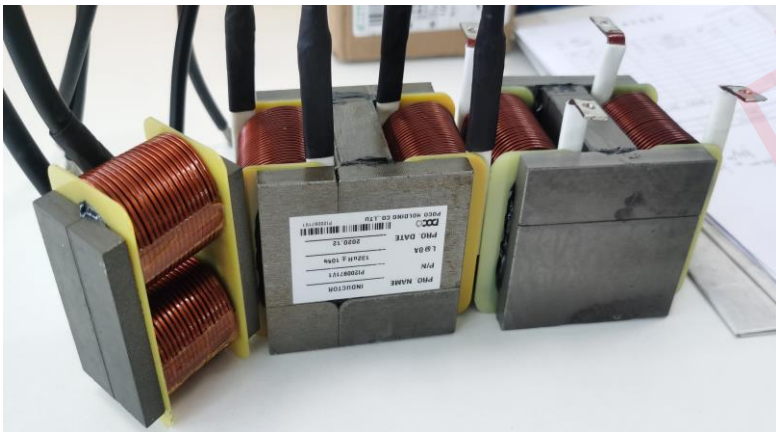
大功率电能变换装置的 磁性元件体积大、重量重
