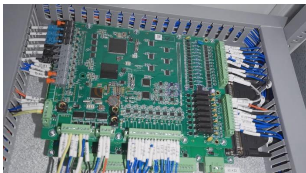
图 17：许继电气 PCS 控制电路板
