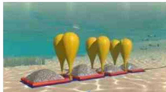
水下气囊储气装置
