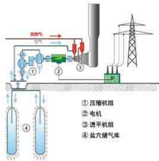
补燃式压缩空气储能系统
