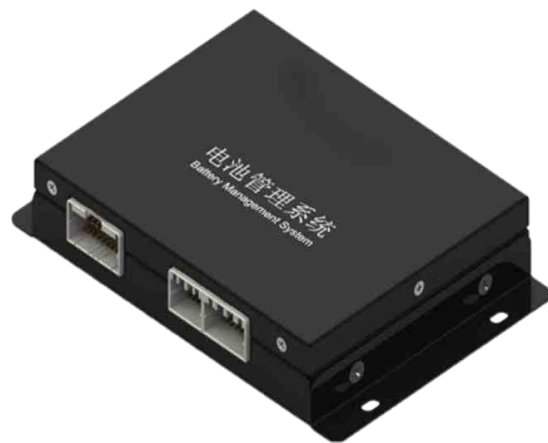
电池管理系统实物图
