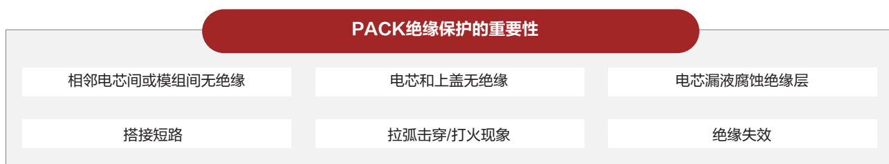
图9: 电池包绝缘保护重要性分析
