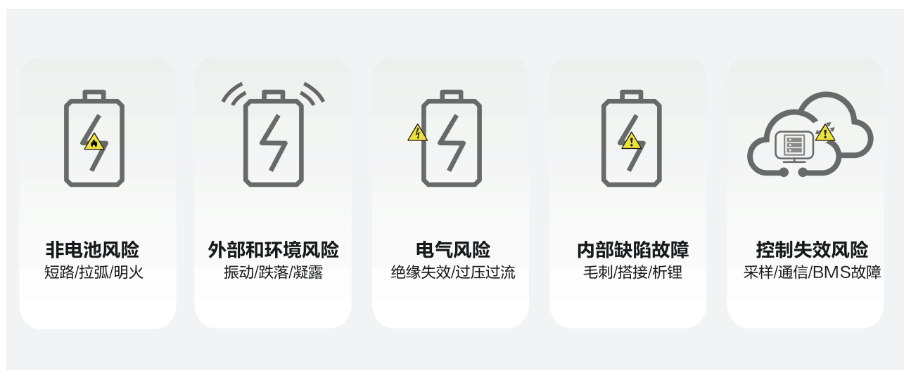
图7. 电气短路故障产生的原因
