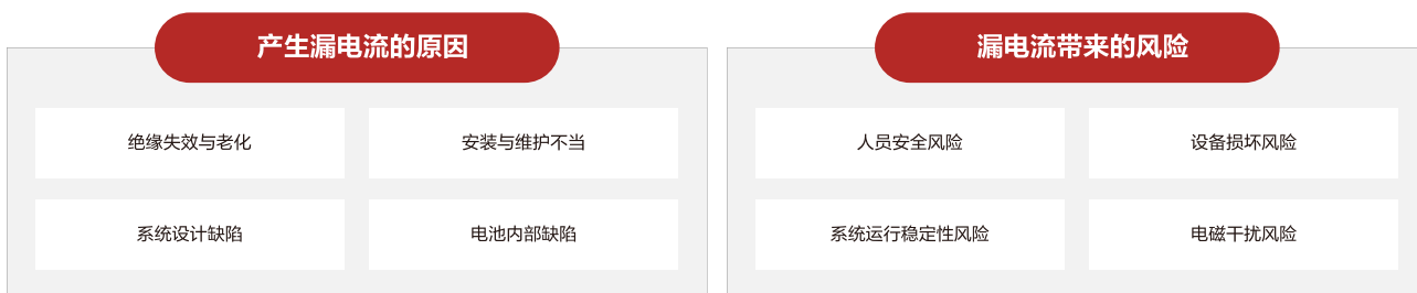
图14. 漏电流产生原因及风险分析
