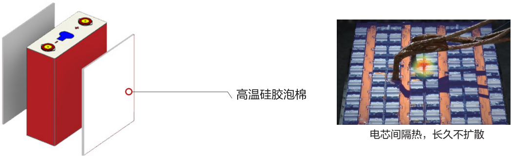
图30：电芯间隔热设计
