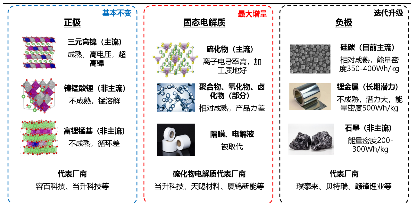
图19：固态电池结构变化
