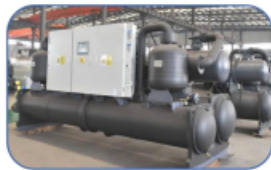
多工况水源热泵机组
