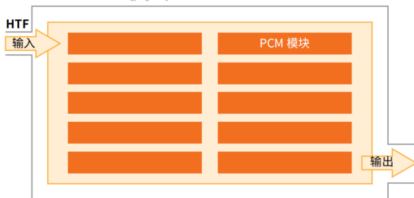
图 2-15: 大容量蓄热系统中的 PCM 封装 (HTF 意味着传热流体【16】)
